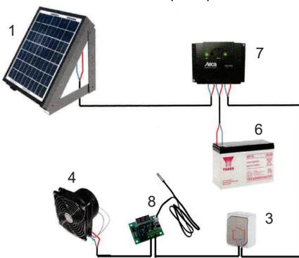
La batterie (6) et le panneau photovoltaïque sont branchés sur le régulateur (7). Celui-ci charge la batterie le jour, jusqu'à sa valeur maximale à partir de laquelle le régulateur coupe la charge.
