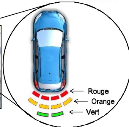
L'affichage au tableau de bord s'active lorsque la distance avec l'obstacle est inférieure ou égale à 2 m. Des voyants verts apparaissent puis oranges, puis rouges au fur et à mesure que le véhicule se rapproche de l'obstacle (voir Document 3). Ils sont accompagnés d'un signal sonore émis par un buzzer dont le rythme s'accélère lorsque la distance diminue.
